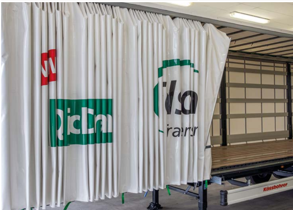
System wird durch mitlaufende Rungen und Ladungssicherungselemente mit wenigen Handgriffen komplett geöffnet. System is opened completely in just a few steps by means of moving stanchions and load securing elements.
