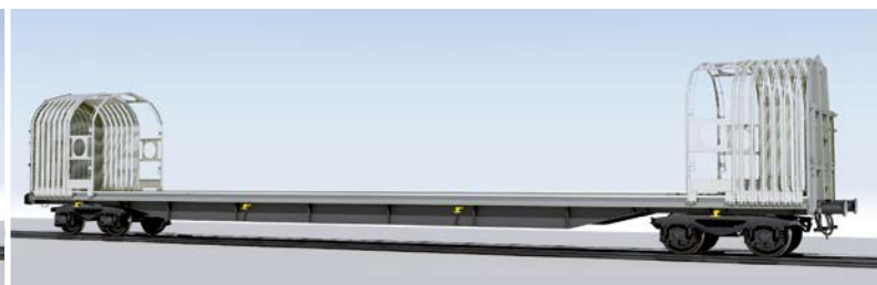
Railway SB • ตัวอย่าง: Rils รุ่นสำหรับสินค้าที่มีขนาดยาว เปิด (ไปยังทั้งสองด้าน)
