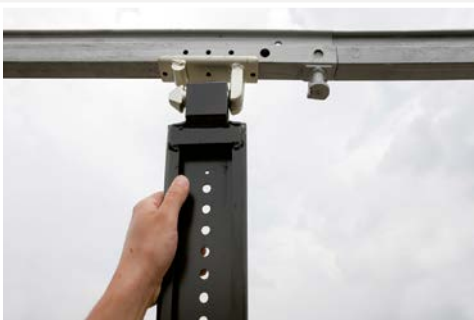
Edscha TS Topkupplung Edscha TS top coupling
