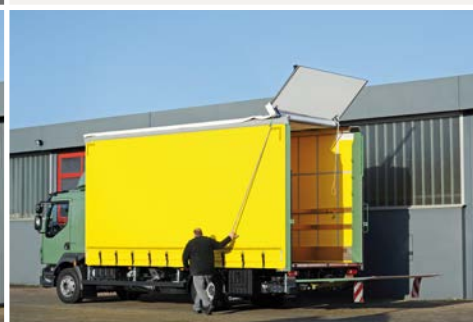
Entriegeln und öffnen des Schiebeverdecks
