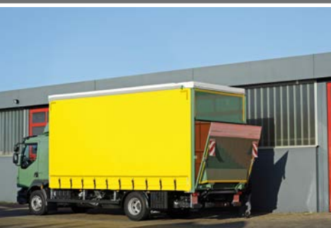
Hydraulisches Öffnen der Ladebordwand
