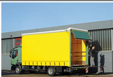
Bedienung und automatisches Aufschwingen des TailWing
