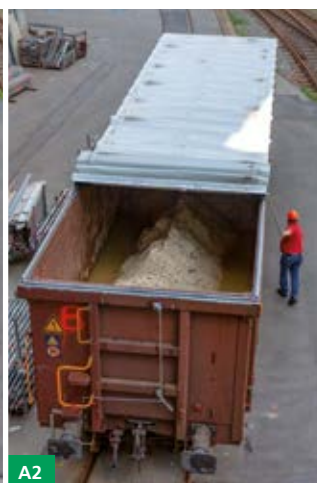
A1 - A3: Öffnungsvorgang, Ein-Mann-Bedienung vom Boden aus A1 - A3: Opening procedure, one-man operation from the ground
