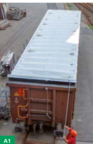
A1 - A3: Öffnungsvorgang, Ein-Mann-Bedienung vom Boden aus A1 - A3: Opening procedure, one-man operation from the ground
