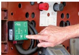
Bedienung direkt am Steuergerät mit Neigungsanzeige und Überlastschutz
