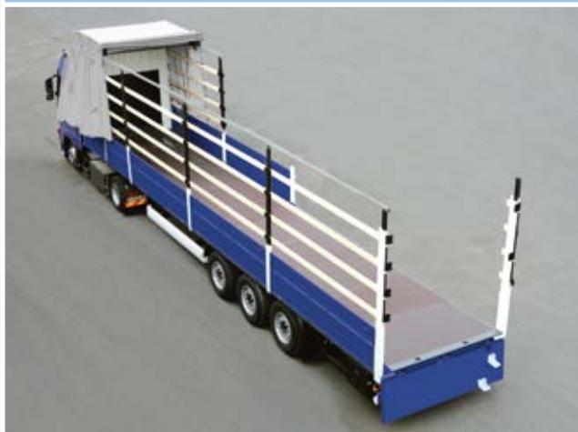
Stahl-Laufschienen Segmente abnehmbar. Auf Wunsch mit Dachpaketabstützung
