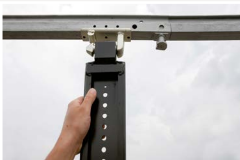
Edscha TS Topkupplung Edscha TS top coupling
