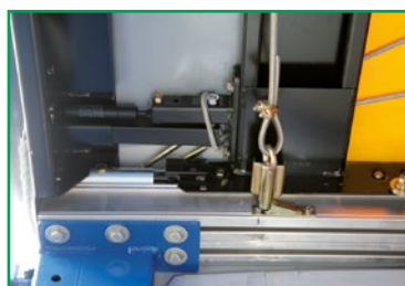
Zugseilverriegelung mit Keil Pullrope closure with wedge
