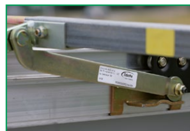
Gelenk mit Rolle-/Rampe-Verriegelung Joint with roller/ramp lock
