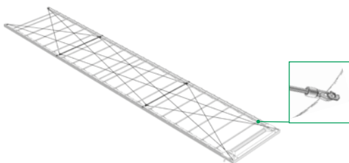
4-Seil Dachaussteifung 4-rope roof reinforcement
