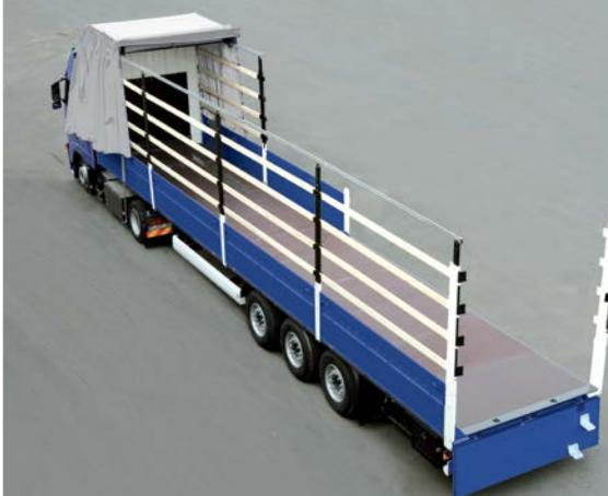
Stahl-Laufschienen Segmente abnehmbar. Auf Wunsch mit Dachpaketabstützung
