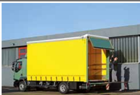
Bedienung und automatisches Aufschwingen des TailWing
