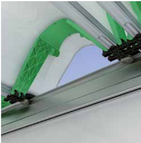
Zuverlässige Planenfaltung durch funktionsoptimierte Kunststoffgelenke
