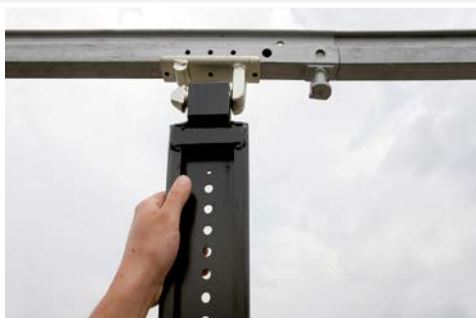
Edscha TS Topkupplung Edscha TS top coupling
