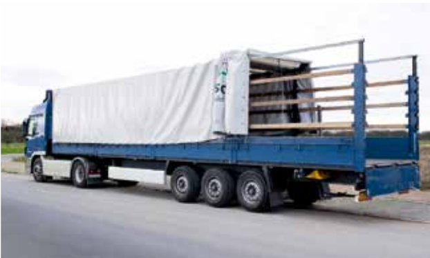
Komple tenteli tavan standardı örneğinde açılma işlemi
