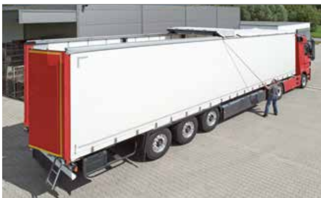
Öppning av taket, till exempel CS-Hybrid
