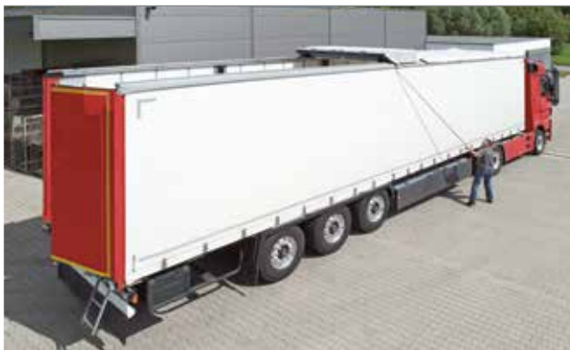
Otwieranie dachu na przykładzie CS-Hybrid
