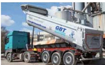
TipperRoof Basculement ouvert
