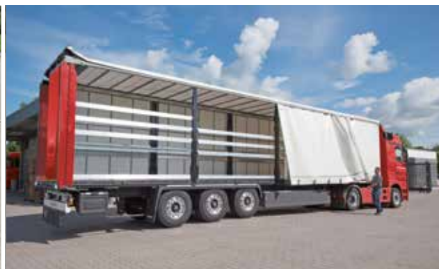
Apertura de la cortina lateral en el CS-Hybrid como ejemplo
