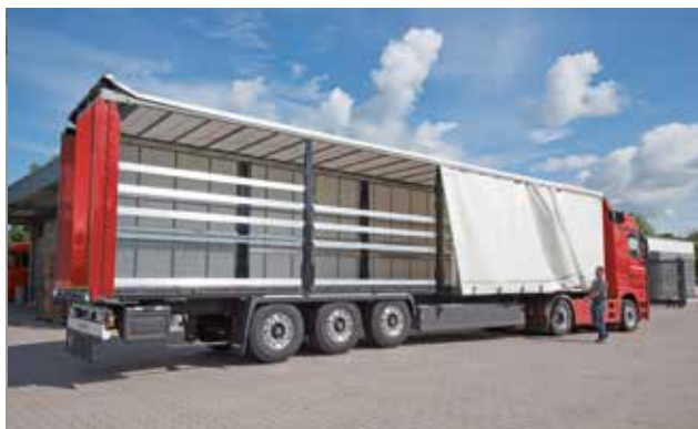
Otevření bočního závěsu na příkladu výrobku CS-Hybrid
