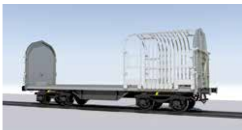
Railway SB - Příklad: Shimmns zakryté, otevřené
