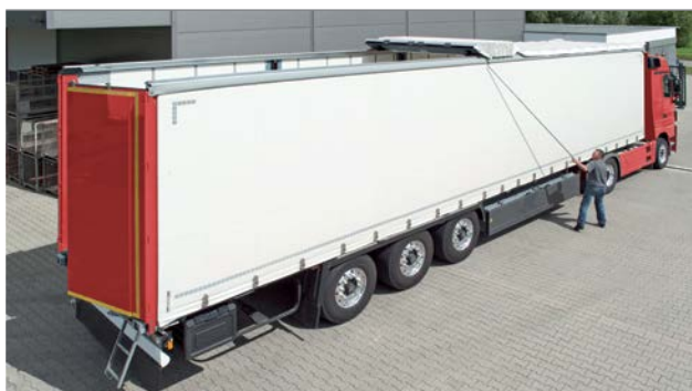
Öppning av taket, till exempel CS-Hybrid
