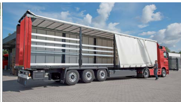
Öppning av sidogardinen, till exempel CS-Hybrid
