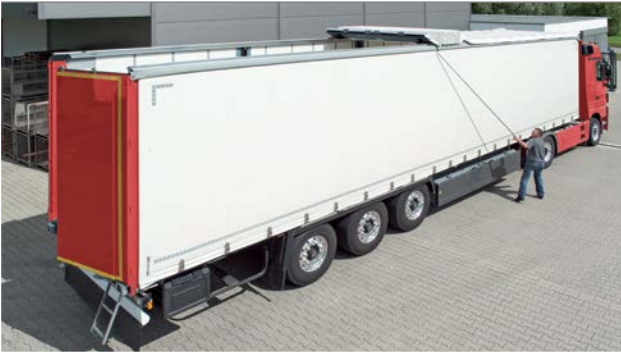
CS-Hybrid örneğinde catinin açılması
