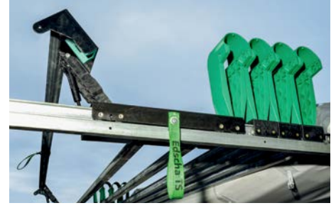
Optimize edilmiş katlama kinematığı sunan dayanıklı mafsallar
