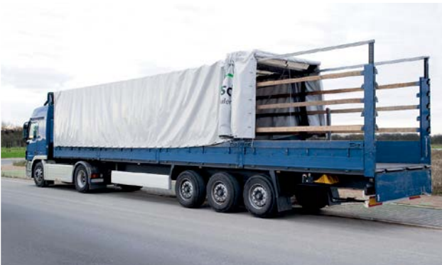
Komple tenteli tavan standardı örneğinde açılma işlemi
