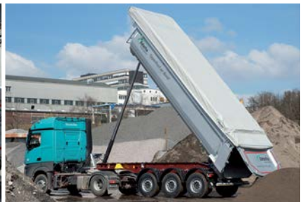
TipperRoof Kapalı şekilde boşaltma
