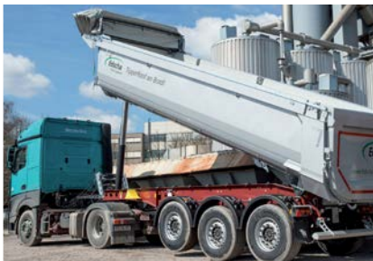
TipperRoof Açık şekilde boşaltma
