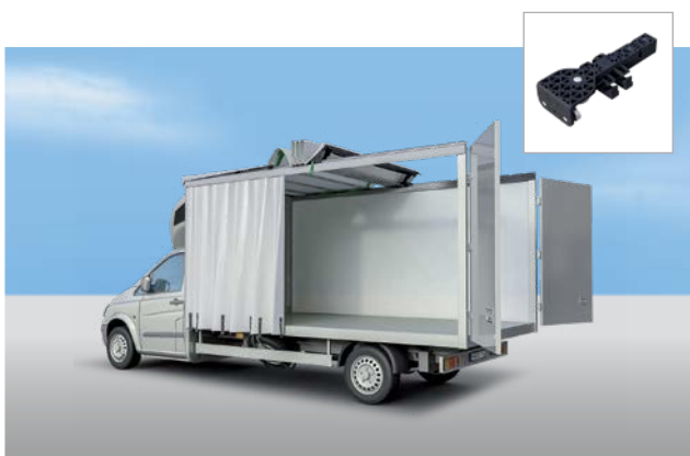
Compact Dach przesuwany kurtynowy / pełna plandeka
