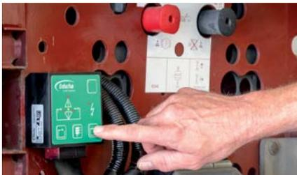
傾斜角度表示と過負荷保護付きコントロールユニットから直接操作
