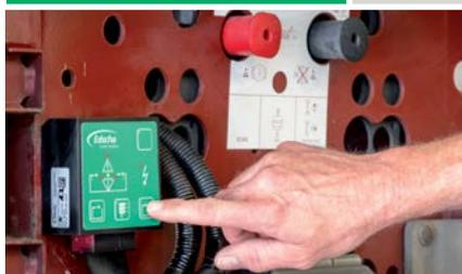
Utilisation directement sur l'appareil de commande avec indicateur d'inclinaison et protection contre les surcharges
