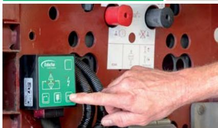
Bedienung direkt am Steuergerät mit Neigungsanzeige und Überlastschutz
