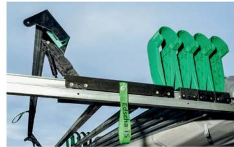
Robuste Gelenke mit optimierter Falt-Kinematik
