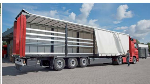
Otevření bočního závěsu na příkladu výrobku **CS-Hybrid**
