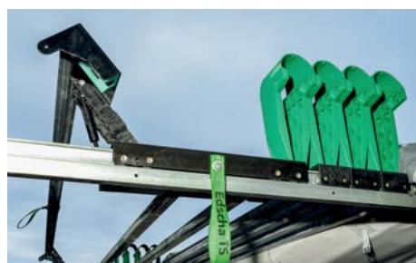
Robustní klouby s optimalizovanou kinematikou skládání
