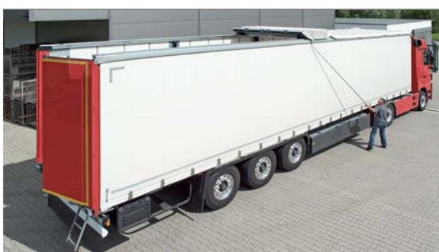
Otevření střechy na příkladu výrobku **CS-Hybrid**
