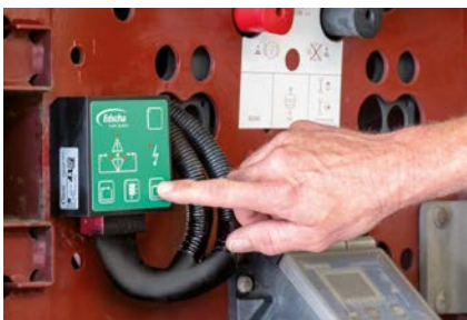
Bedienung direkt am Steuergerät mit Neigungsanzeige und Überlastschutz
