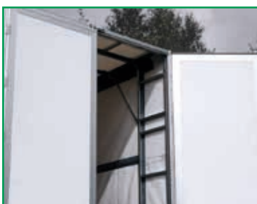
Optionale Hecktüren mit Verdeck verschiebbar Optional rear doors slidable with roof
