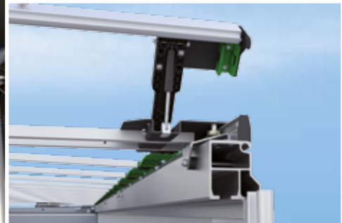
Portalbalken entriegeln und Verdeck ziehen Unlock portal beams and pull roof
