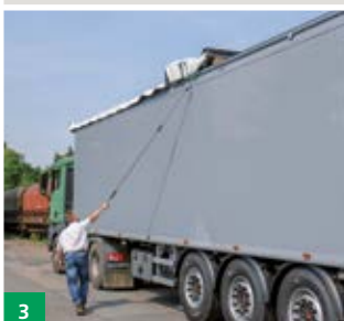
Öffnungsvorgang, Ein-Mann-Bedienung vom Boden aus Opening procedure, one-man operation from the ground
