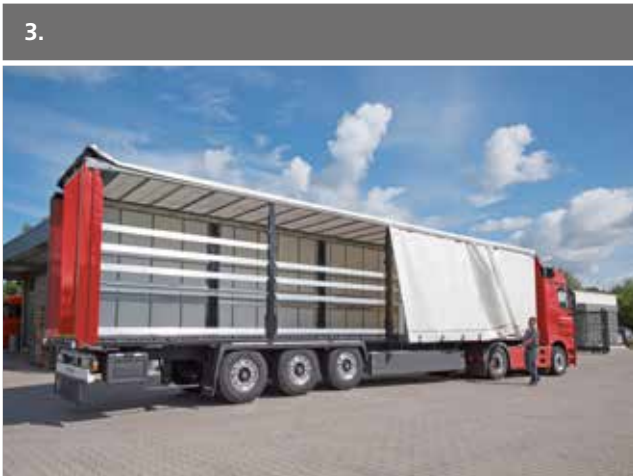
■ Max. freitragende Öffnung ca. 85 - 90% der Aufbau­länge (TIR 75-80%)
