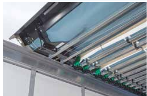
Heckabschluss mit Edscha-TS-Portabalken Standard 130/190. Weitere Heckabschlussvarianten: TailWing und HD-Abschluss.
