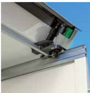
Aufstellautomatik ermöglicht volle Durchladehöhe Automatic installation allows a full loading aperture height
