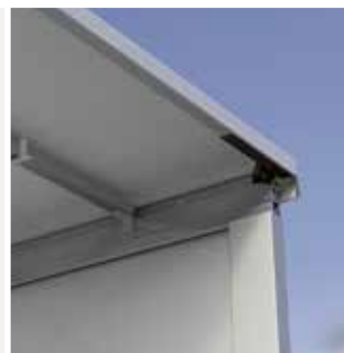
Festdach mit fixiertem Endspriegel Fixed roof with fixed end bow
