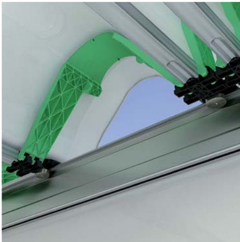
Zuverlässige Planenfaltung durch funktionsoptimierte Kunststoffgelenke
