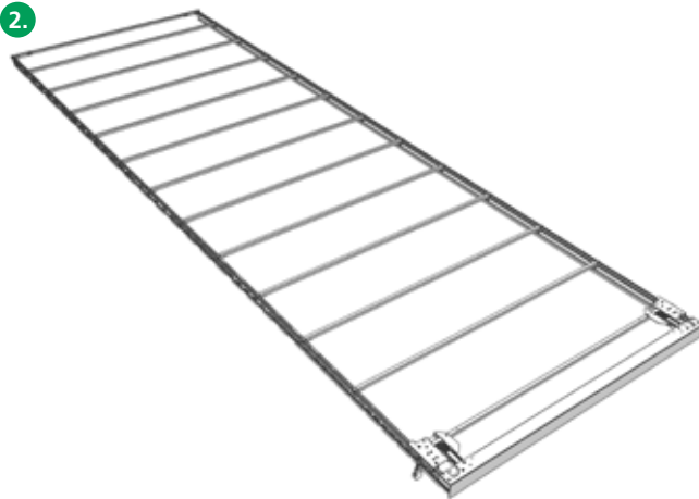
Endlaufwagen - Portalbalken Endcarriage - gantry beam
