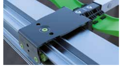
HİBRİT yapı türüne dayanan sağlam ve şeklini koruyan yük arabaları
