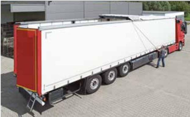
CS-Hybrid örneğinde tavanın açılması
