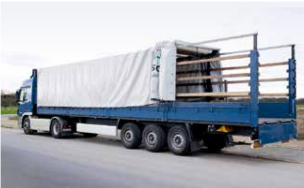
Komple tenteli tavan standardı örneğinde açılma işlemi
