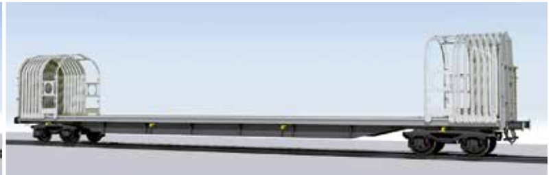
Railway SB - Örnek: Rils modeli, uzun yükler için, açık (her iki yana doğru)
