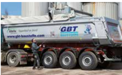
TipperRoof Açma işlemi
