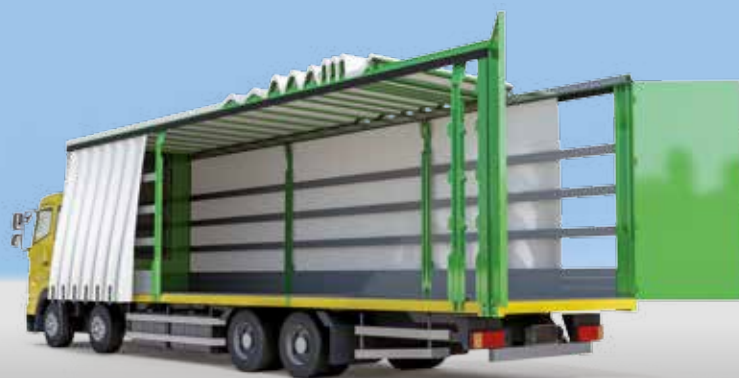
Верх кузова с боковыми стенками-шторками VARIO-CS
