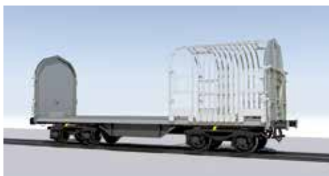
Railway SB · Пример: Складной верх вагона Shimmns, открытый
