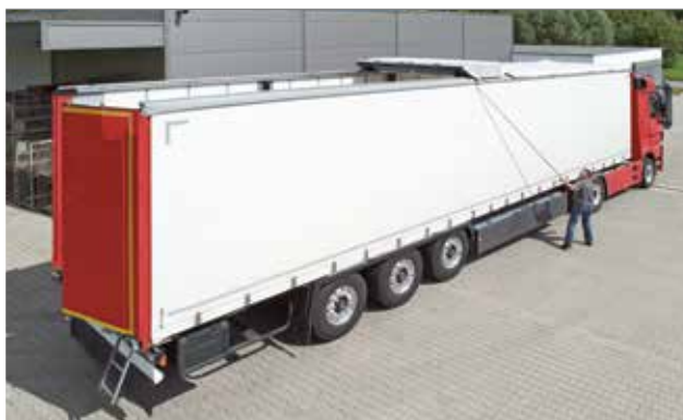
Otwieranie dachu na przykładzie CS-Hybrid
