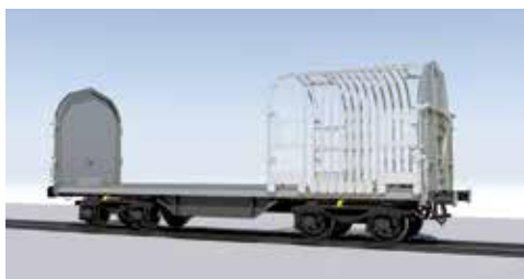
Railway SB - przykład: Dach Schimmns, otwarty
