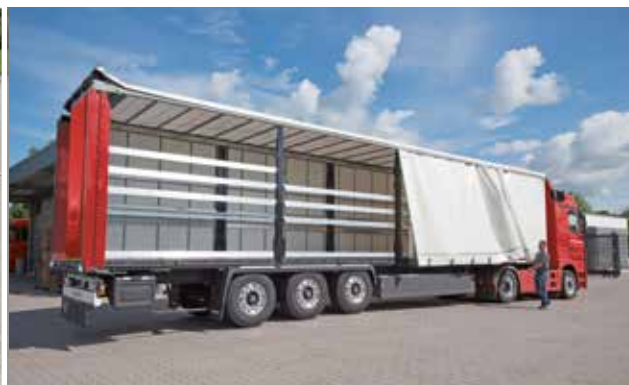
Otwieranie kurtyny bocznej na przykładzie CS-Hybrid
