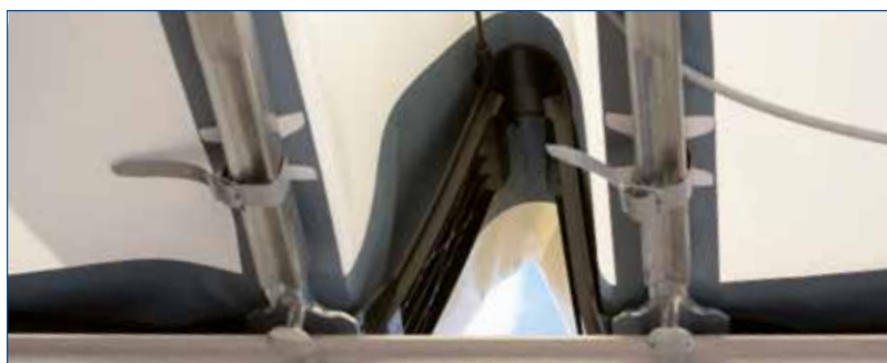
Robuste Gelenke mit Einschubsystem und Bohrung für Expanderseil (XL-Seile ragen nicht in den Laderaum) Robust joints with insert system and drill holes for expander cable (XL cables do not protrude into cargo space)
