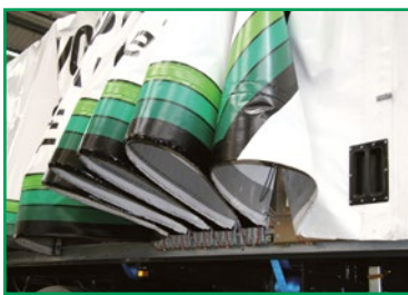
Sauber gefaltete Plane durch Ausstellfedern und patentierte Befestigung Tidily folded tarpaulin through leaf springs and patented attachment
